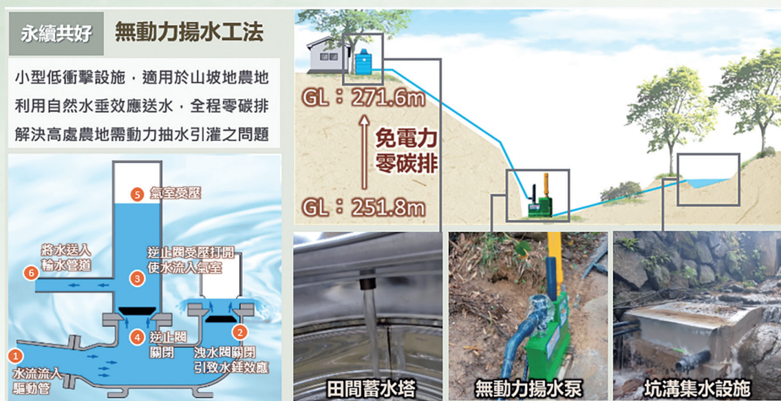
圖3 無動力揚水設施示意與建置成果
