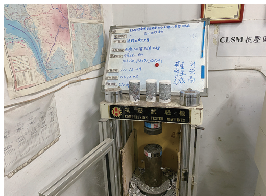
西勢圳等改善工程混凝土鑽心抽驗作業
