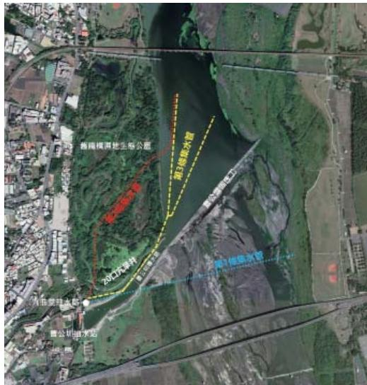
圖3、九曲堂抽水站集水管配置示意圖
