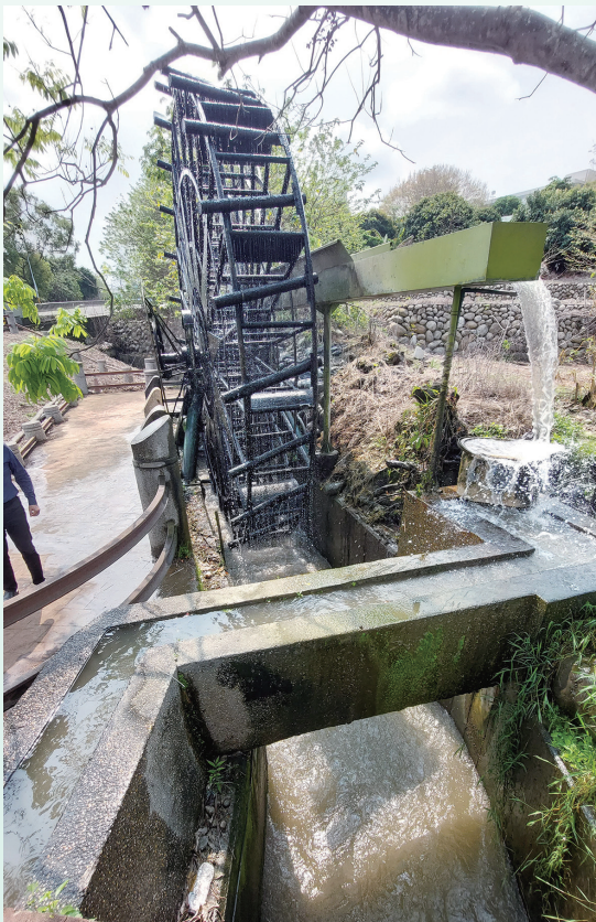
水車係利用水流力量迴轉大車輪汲水
